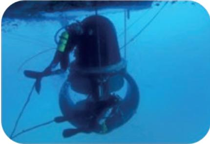
CAMBIO DE THRUSTER AZIMUTAL
