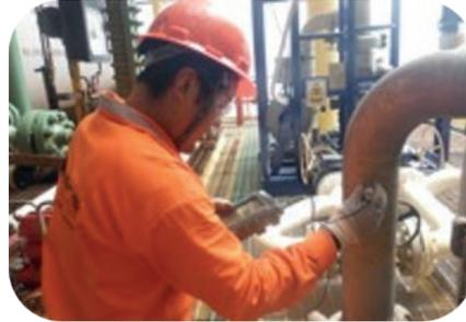
MEDICIÓN DE ESPESORES
